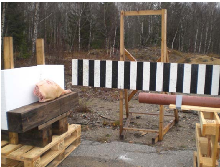
Figur 1. Uppställning av prov med fyrverkerier med mindre än 75 g pyroteknisk sats.
