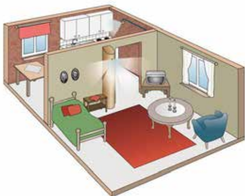
En mobil sprinkler installerad på väggen i vardagsrummet.
